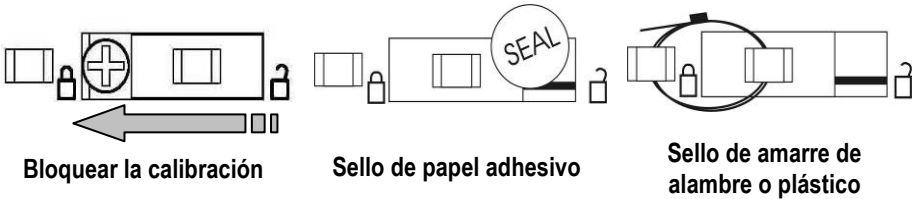
Figura 4-1. Bloqueo y sellado del interruptor del seguro de calibración
