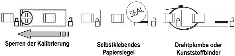
Abbildung 4-1. Sperren und Versiegeln des Kalibrierungssperrschalters
