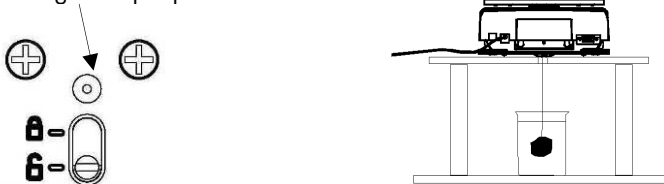
Figura 4-2. Impostazione per l'utilizzo del gancio per pesa da sotto
