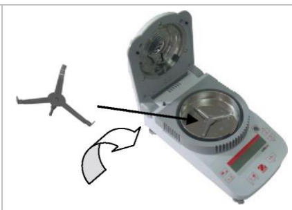
(2) Installez le support du plateau, tournez jusqu'à ce qu'il s'engage pour se mettre en place
